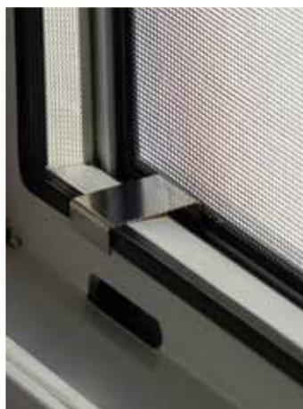
Der Einsatz eines Rahmens mit Insektenschutz-Gaze ist dann sinnvoll, wenn schnelles Öffnen und Schließen weniger wichtig ist. Die Befestigung erfolgt als Einhängerahmen, auch über Scharnier drehbar oder ganz einfach über Magnethalterung. Der robuste Aluminiumrahmen hat stabile Eckverbindungen und kann bei größeren Formaten mit einem Mittelsteg verstärkt werden. Das Aluminiumprofil ist in weiß, braun und allen RAL-Farben erhältlich.
